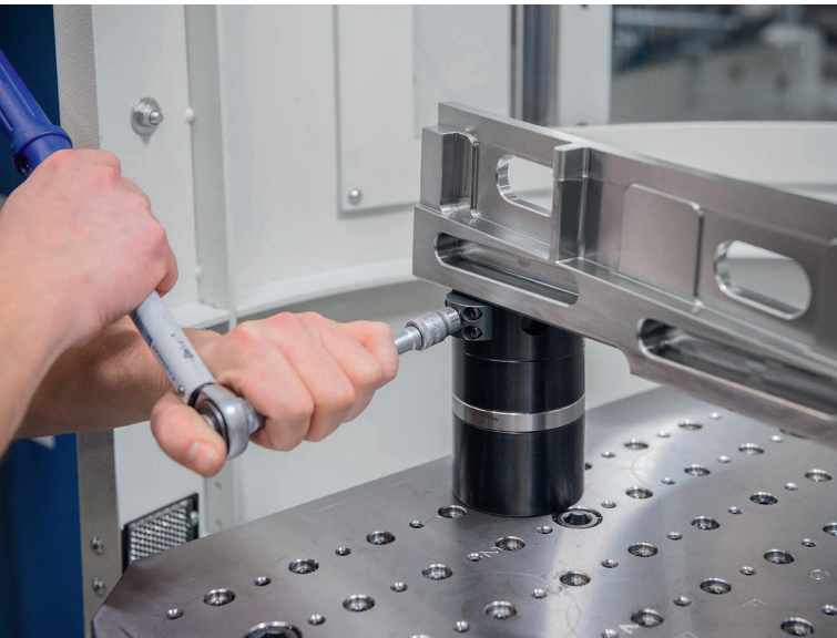
2 Mit wenigen Handgriffen ist das Werkstück manuell im Nullpunkt-Spannsystem gespannt © AMF
